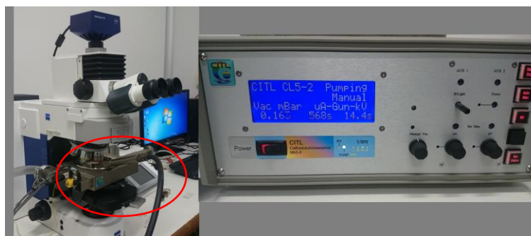
Figura 1: À esquerda - Microscópio Ótico do CETEM com compartimento especial para análise de catodoluminescência. À direita: Equipamento de catodoluminescência onde são ajustadas as condições da análise.
