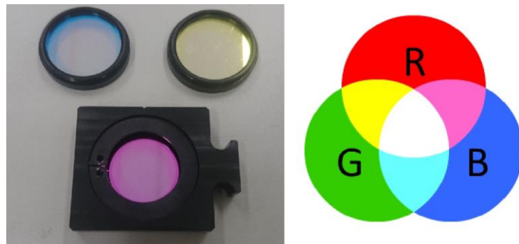
Figura 3: À Esquerda: filtros RGB utilizados na análise da catodoluminescência em Microsonda Eletrônica. À Direita: o Sistema RGB que forma as demais cores.
