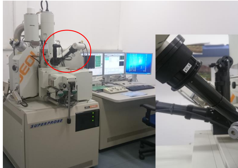
Figura 2: Microsonda Eletrônica do LABSONDA-UFRJ com o detector de catodoluminescência acoplado. Em destaque à direita é mostrado onde ocorrem as trocas dos filtros L-RGB.
